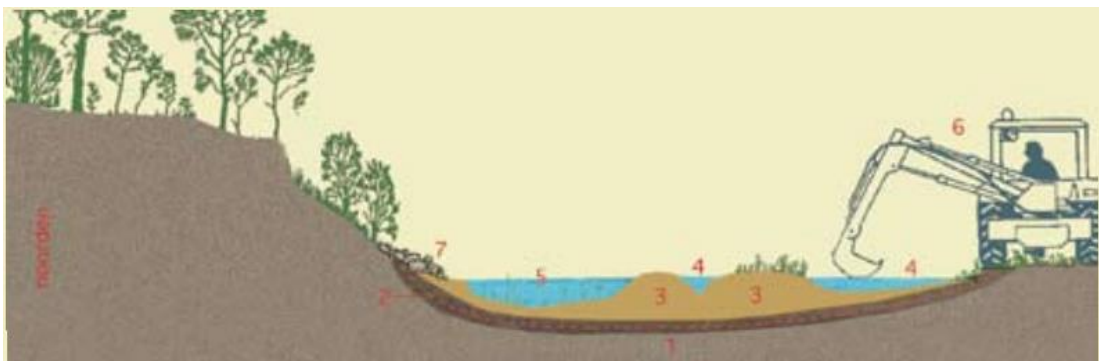
Figuur 39: Dwarsprofiel betonnen poel
